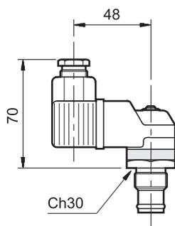
Questo tipo di indicatore oltre ad avere una segnalazione visiva come il modello VM, interviene modificando lo stato di un contatto elettrico al raggiungimento del limite di intasamento dell'elemento filtrante.
