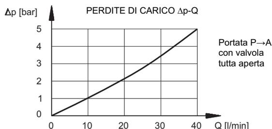
**NOTA:** Per flusso A→P, con valvola chiusa, aggiungere ai valori riportati nel diagramma la pressione di apertura (0,5 bar)
